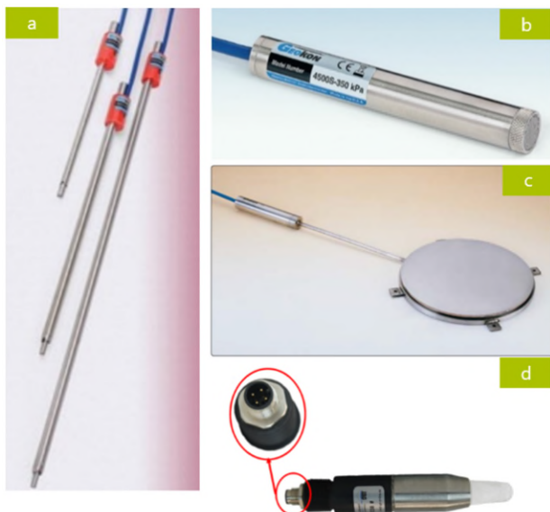
Figure 3: Instruments installés (a: élongamètres, b: piézomètre, c: cellule de pression totale, d: tensiomètre à haute capacité)
