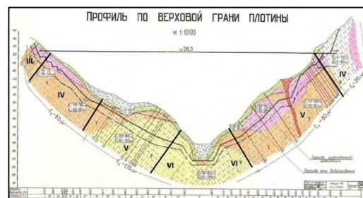
Figure 3. Coupe verticale à travers la fondation du barrage montrant les limites entre unités géologiques (modifiée de Centre de recherche géodynamique, 2019)
