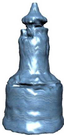
Figure 2 : Reconstitution de la forme 3D de la cavité EZ53 à partir de l'échométrie (mesure sonar) réalisée en 2023.
