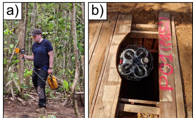
Figure 2. Photographies du matériel d'acquisition, a) GeoSLAM ZEB HORIZON (acquisitions de surface), b) Drone Elios 3 (acquisitions en souterrain, en puits et en galeries).
