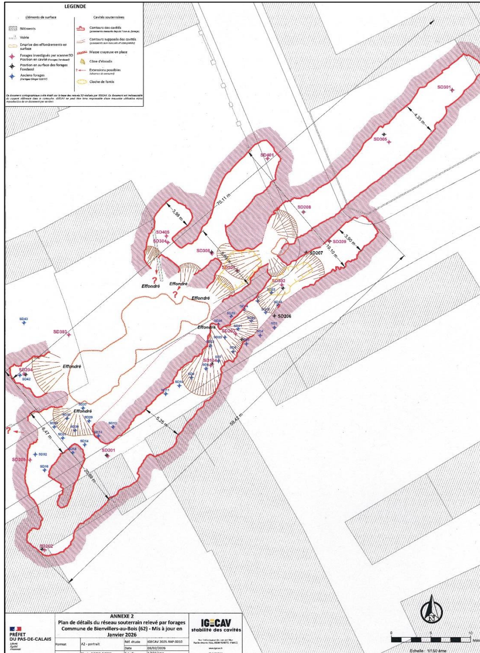
Figure 9: Plan des cavités souterraines relevées par forages à proximité de la rue Cocriamont à Bienvillers-au-Bois (IGECAV)
