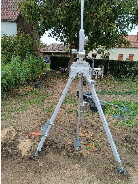
Figure 5 : Photographie du dispositif de scanner laser 3D en forage
