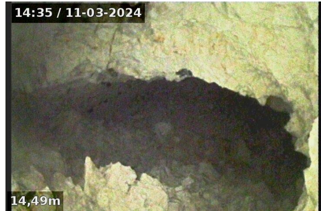
Figure 2: Photographie du vide observé en forage
