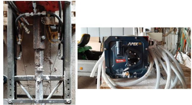
Figure 6. Système hydraulique d'injection et pompe Bredel APEX20
