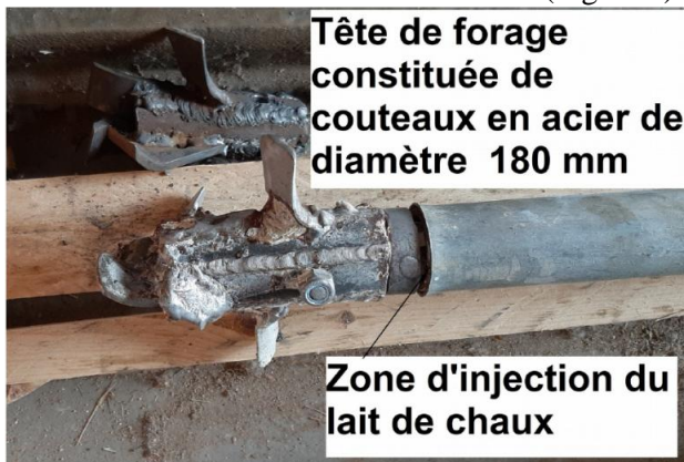
Figure 5. Tête de forage et d'injection expérimentale, 2019
