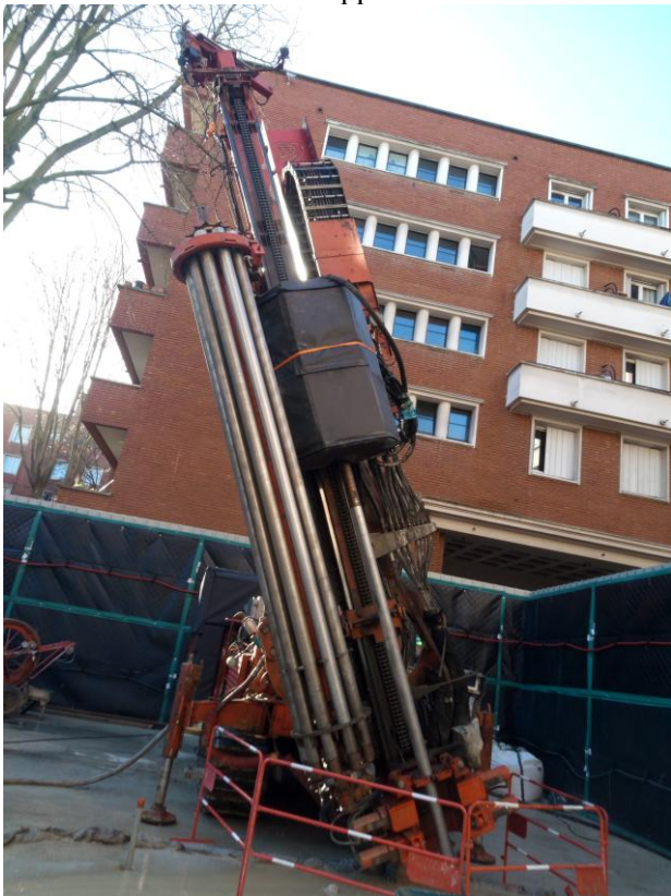
Figure 14. Exemple de foreuse Hi'Drill® équipée d'un système de réduction de bruit au niveau de la tête et du porteur
