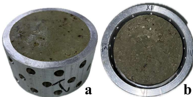
Figure 4. Eprouvette en place dans les bagues spéciales avec ouvertures latérales conçues pour l'essai de retrait sous chargement : a- en début d'essai, b- en fin d'essai
