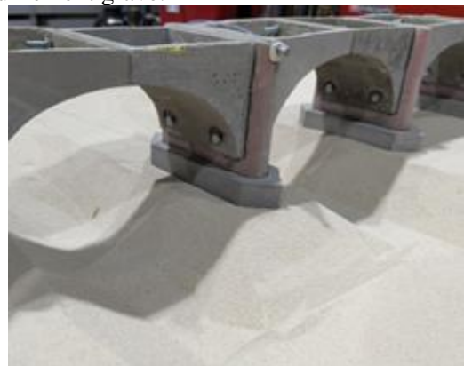
Figure 11. Modèle de pont en arc avec affouillement symétrique de 50 mm de profondeur (Reiffsteck)
