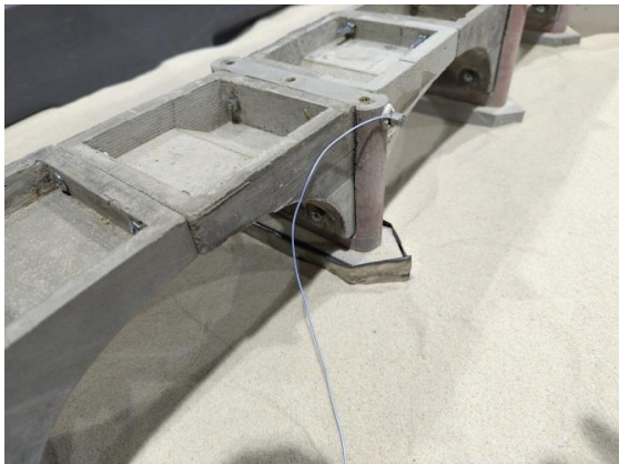
Figure 16. Vue de la pile avec parois de palplanches
