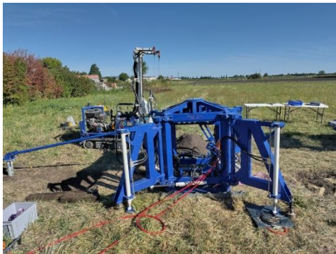
Figure 19. Vue de la rotule et du vérin appliquant une charge inclinée et vue latérale avec le tirant
