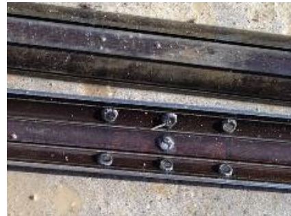
Figure 6. Les deux parties du tube fendu avec les aimants attachés
