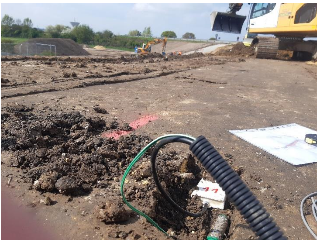
Figure 4. Sonde de teneur en eau (boîtier blanc et sonde de succion (cylindre gris et vert) posés côte à côte dans la recharge du talus
