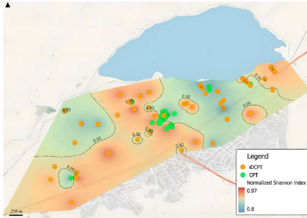
Figure 7. Variabilité de la résistance au cône obtenue à partir des essais iDCPT et CPT. Indice de Shannon normalisé – Gölbaşı (Turquie).
