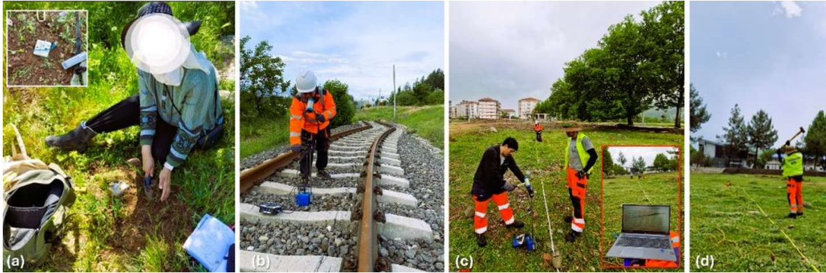
Figure 1. Essais géophysiques et géotechniques portables : (a) HVSR, (b) iDCPT (Panda), (c-d) iDCPT (Panda) et mesures 2D-MASW. Illustrations des mesures iDCPT (Panda®) et 2DMASW réalisées à Gölbaşı (Türkiye) en mai 2024
