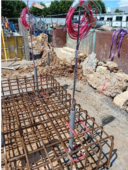
Figure 10. Dispositif de mesure des déplacements des têtes d'inclusions
