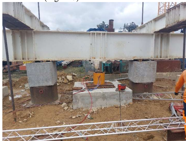
Figure 7. Dispositif de réaction pour chargement vertical
