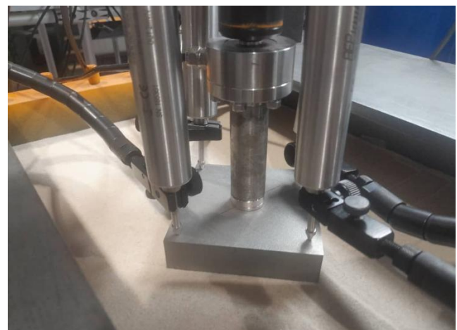
Figure 5. emplacement des capteurs de déplacement
