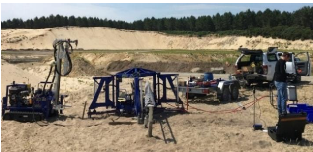
Figure 5 : Essais de chargement à échelle réelle
