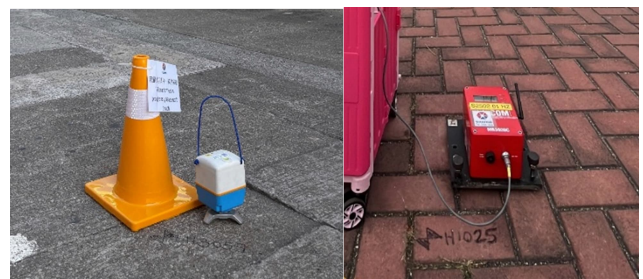
Figure 8. Mise en œuvre des acquisitions HVSr (gauche : Smartsolo 3C, droite : Syscom MR3000)
