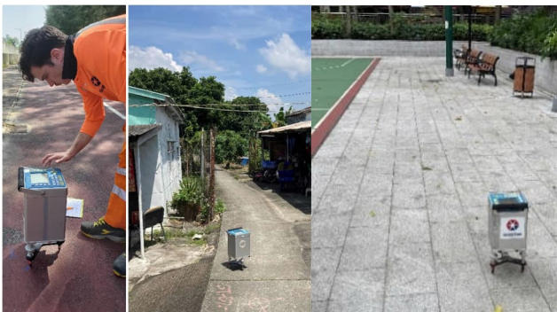
Figure 6. Mise en œuvre du MicroGravimètre Scintrex CG5
