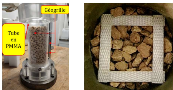
Figure 6. Photographie de l'échantillon scanné montrant l'installation d'une maille de géogrille
