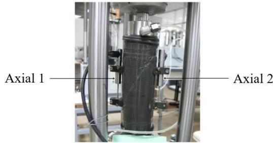
Figure 8. Photographie d'une éprouvette de sol traité équipée de 2 capteurs LVDT
