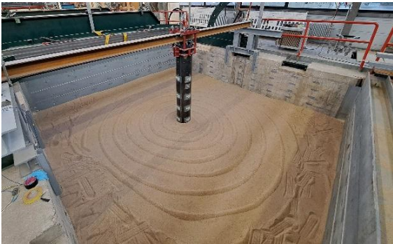
Figure 4. Photographie d'un essai en cours de préparation : remplissage et compactage du massif de sable autour du pieu.
