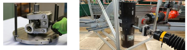
Figure 6. Système articulé à l'intérieur du pieu (gauche) pour fixation des deux vérins en tête du pieu (droite) pour le Test 2.
