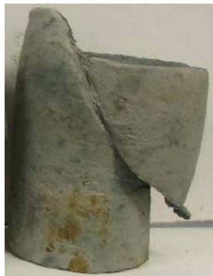
Figure 3. Éprouvette d'argile cisailée à l'essai triaxial (à 2V_{CIU+u} )
