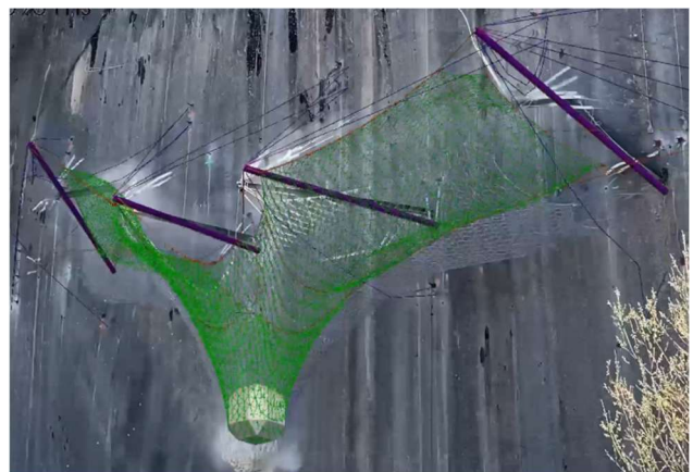
Figure 20 : Visuel de la superposition de l'essai numérique à l'essai expérimental
