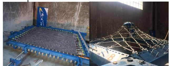
Figure 10 : banc d'essais dans le plan et hors plan
