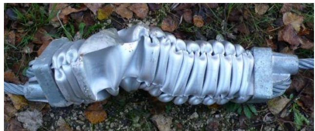
Figure 6. Dissipateur testé par sollicitation dynamique
