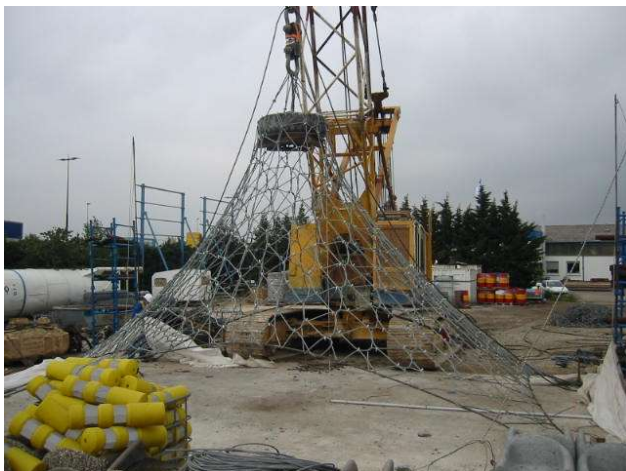
Figure 3. Essai quasi-statique sur un filet
