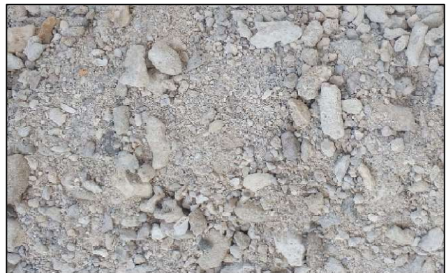
Figure 1 : Photographie d'un échantillon de sol pulvérulent carbonaté
